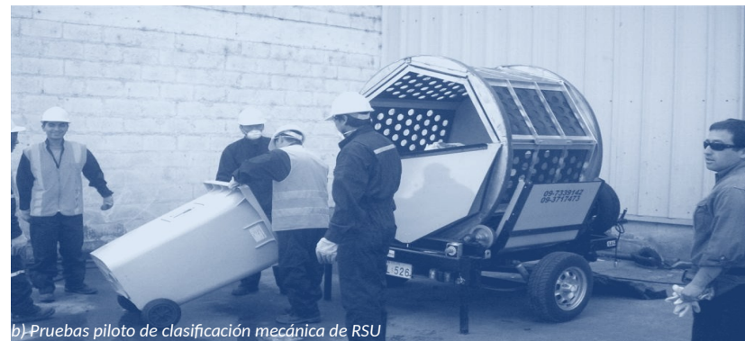
b) Pruebas piloto de clasificación mecánica de RSU
